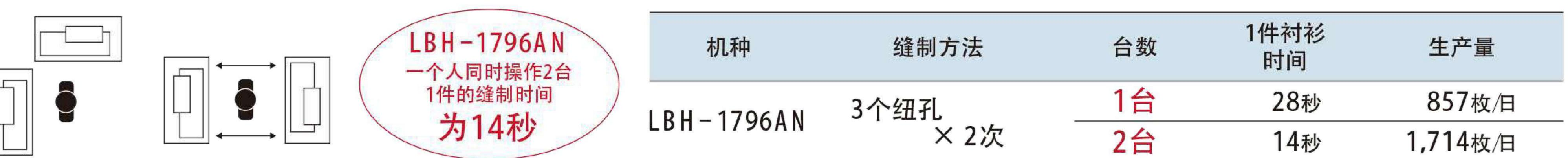
条件:6个纽孔,转速3,600s it/m in,浮余率20%,身片设置时间6.5秒,锁眼时间9.5X2次(6个纽孔,孔间距100m m),操作多台时,缝纫机之间移动2秒,锁眼设置时间4.0秒。
